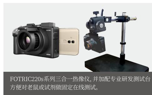
FOTRIC220s系列三合一热像仪，并加配专业研发测试台方便对老鼠或试剂做固定在线测试。
