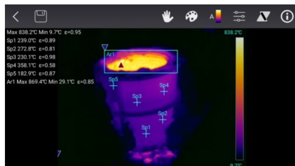
灵活设置各区域不同发射率，实现不同材质单独准确测量
