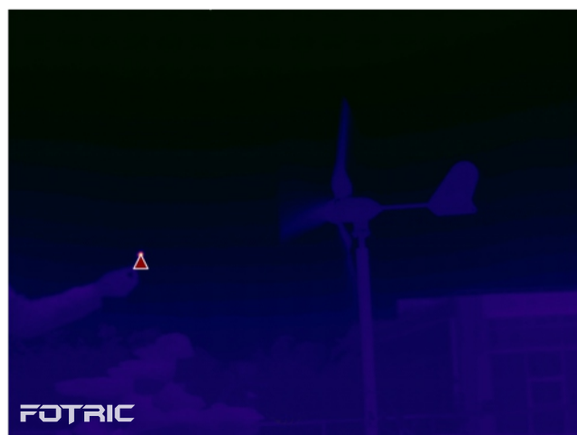
高温差均衡成像技术开启前的热像图
