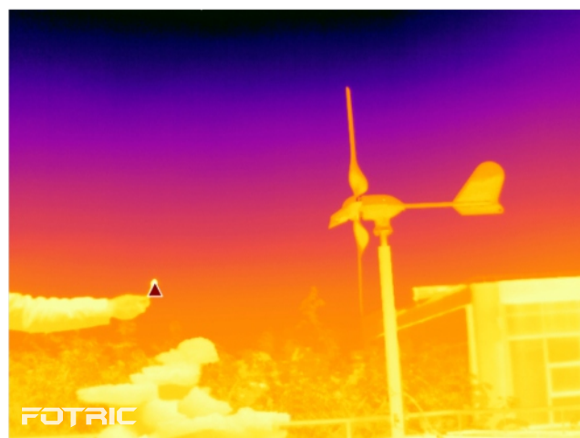
高温差均衡成像技术开启后的热像图
