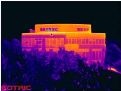
使用L91-236广角镜头在18米外检测28米跨度建筑外立面
